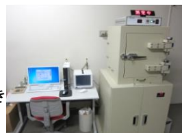
ゲルマニウム半導体検出器付き ガンマ線スペクトロメーター
