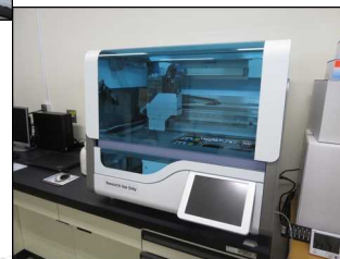
追加した自動核酸精製装置
