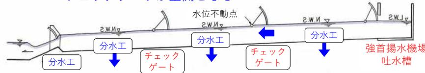
**0 < Q < 最大** 各分水工からの取水量に伴い、当該区間の水が低下。これに応じ上流側のゲートが開度を自動調整。
