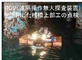
ROV(遠隔操作無人探査装置)を活用した棧橋上部工の点検
