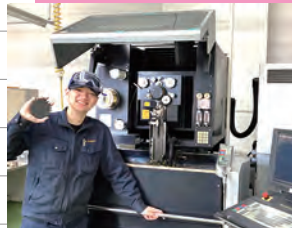
▲ ワイヤ放電加工機にて歯車を製作しました。
