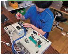
▲ PLCを用いてコンベアや各種機器を制御しています。
