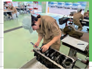
▲ 自動車から取り外し分解したエンジンの測定を行います。
