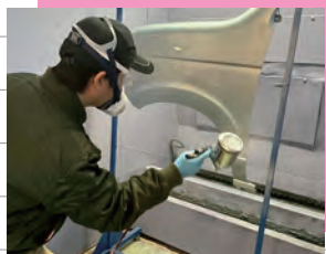
▲ 実車パネルに仕上げのクリアーを吹付けています。
