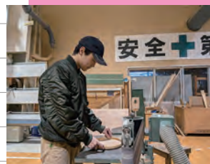
▲ ベルトサンダーで木地の形を整え、木工塗装で仕上げます。
