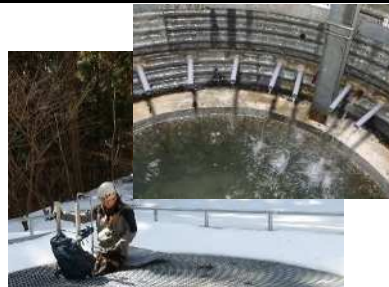
集水井内水質分析試料採水状況
