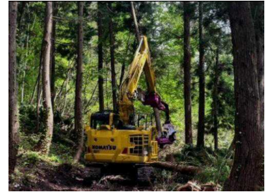
伐倒機械による伐倒作業
