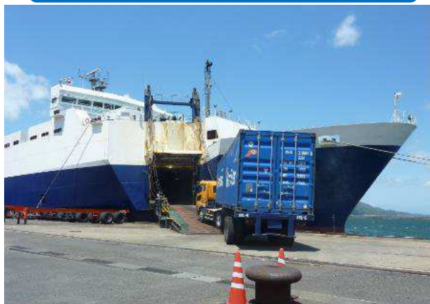
RORO船の荷役状況
