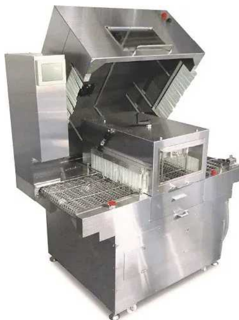
〈図〉物高交付金により導入されたジェットエア式除水機
