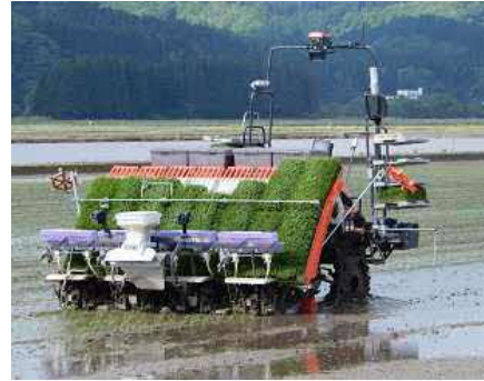
〈図〉自動操舵トラクタによるネギの4工程同時作業
