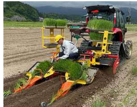
〈図〉自動操舵トラクタによるネギの4工程同時作業
