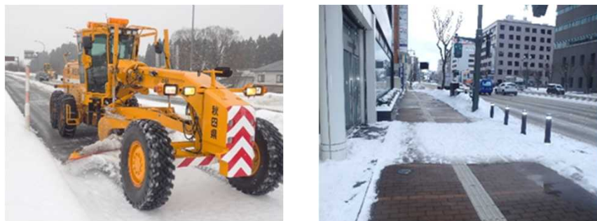
道路除雪・歩道融雪施設状況
