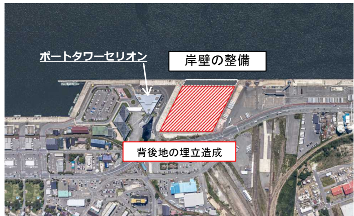
本港地区 岸壁整備
