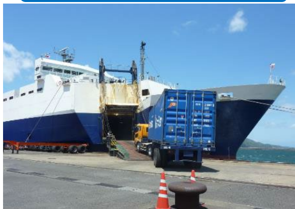
RORO船の荷役状況
