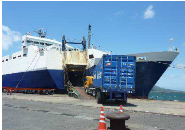
RORO船の荷役状況
