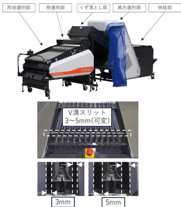
図1 エダマメ粗選別機(上:全体、下:形状選別部)
