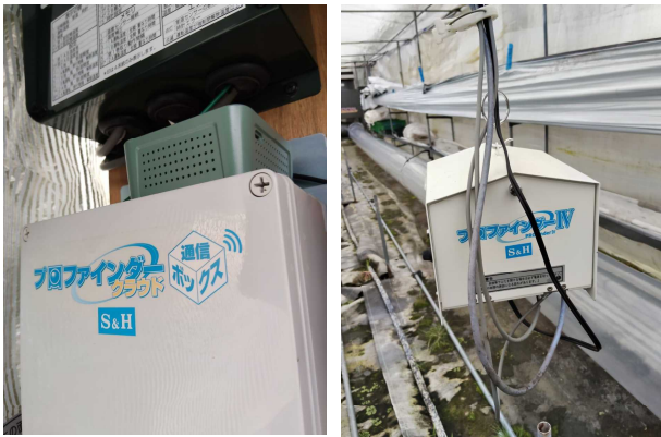
【温度・湿度・日射量・CO 2 濃度等を計測】
