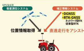
直進アシスト田植機の仕組み
