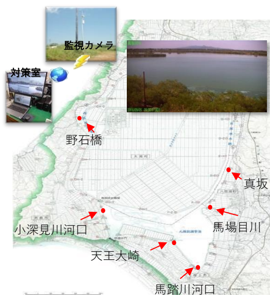
図 34 アオコ常時監視システム
