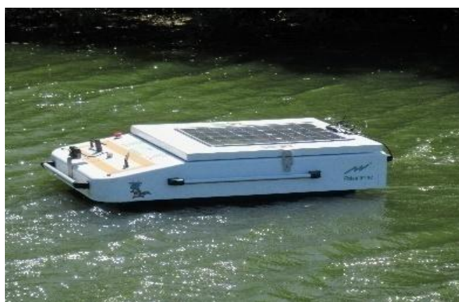
図 37 自走式アオコロボット（寸法：全長 1,310mm×全幅 1,000mm×全高 635mm）
