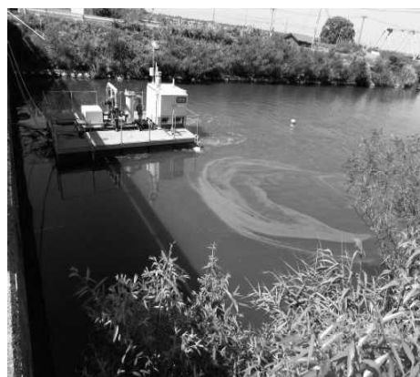
アオコ抑制装置による悪臭被害防止対策
