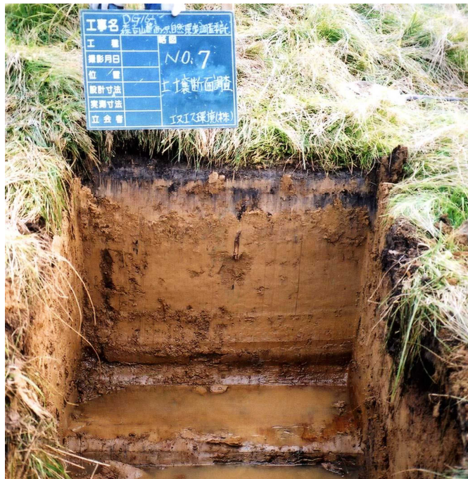
写真4-4-1 事業対象地の土地断面図の一部 A層が薄く、停滞水がある。
