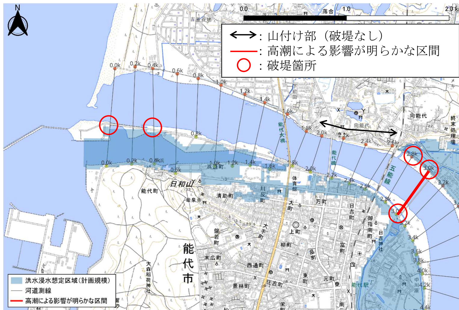
図 破堤箇所(米代川)
