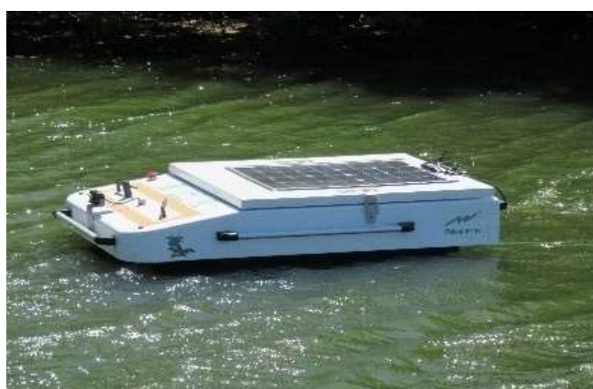
図 36 アオコ抑制装置側面図（寸法：全長 5,200mm × 全幅 3,690mm）
