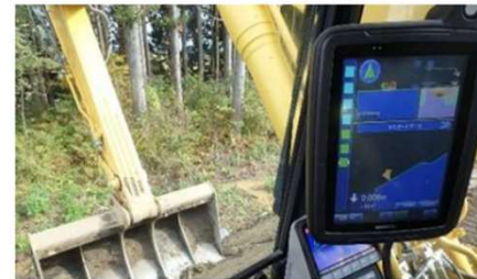
ICT 建設機械による施工状況
