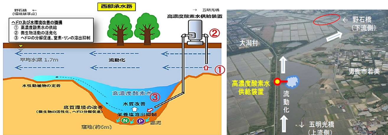
図 17 高濃度酸素水供給装置
