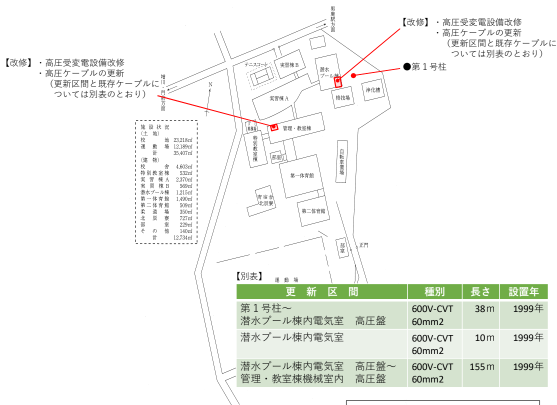
電気設備 高圧ケーブル更新 区域図
