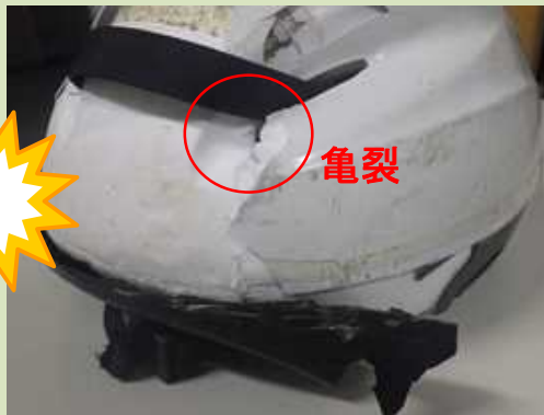
【自転車のヘルメットの損傷状況】
