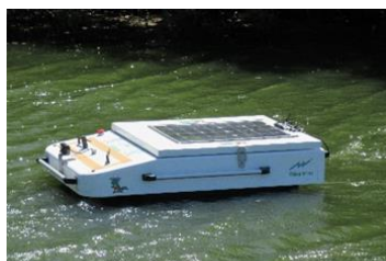
アオコ発生抑制装置(自走式アオコロボット)
