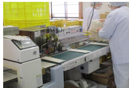
ロータリーヒートシール機
