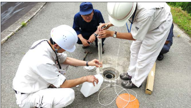
図13 地下水の採取（災害廃棄物）
