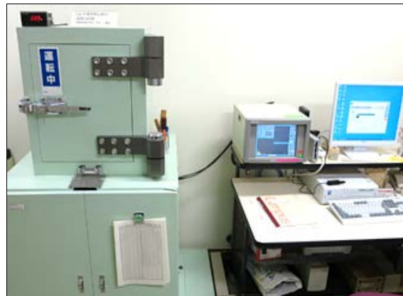
図5 ゲルマニウム半導体検出器付き ガンマ線スペクトロメーター 1号機 (SEIKO EG&G 社製)
