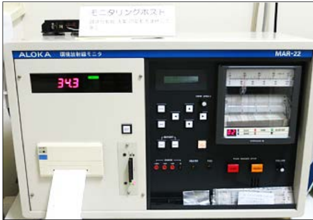
図2 モニタリングポスト計測器 (日立アロカメディカル社製 MAR-22)
