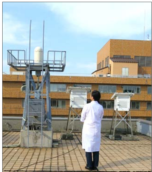
図 1 当センター屋上の モニタリングポスト検出器
