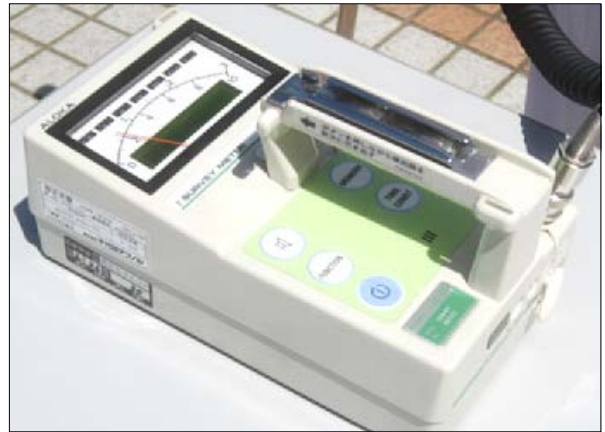
図3 エネルギー補償型 NaI シンチレーションサーベイメータ (日立アロカメディカル社製 TCS-171B)
