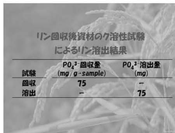
図9 リン回収後もみ殻炭のク溶性試験結果
