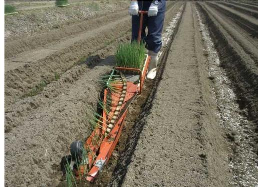
実証：耕起・畝立・溝切・施肥・定植の同時作業
