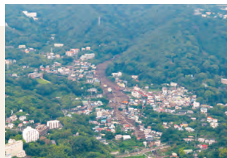
令和3年7月静岡県熱海市／大雨に伴い盛土が崩落し大規模な土石流が発生。死者28名、住宅被害98棟
