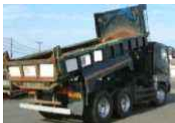
【ダンプ車】 自動車検査証の車体の形状欄に「ダンプ」「ダンプフルトレーラ」 「ダンプセミトレーラ」と記載のあるものであって、土砂等の運搬 に供されるもの ※自動車検査証の備考欄に「積載物は、土砂等以外のものとする。」等 の記載があり、土砂等の運搬が制限されているものは、評価の対象 にはなりません。
