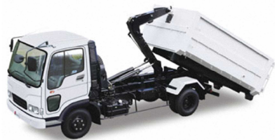
図2-6-4-3 脱着装置付コンテナ自動車
