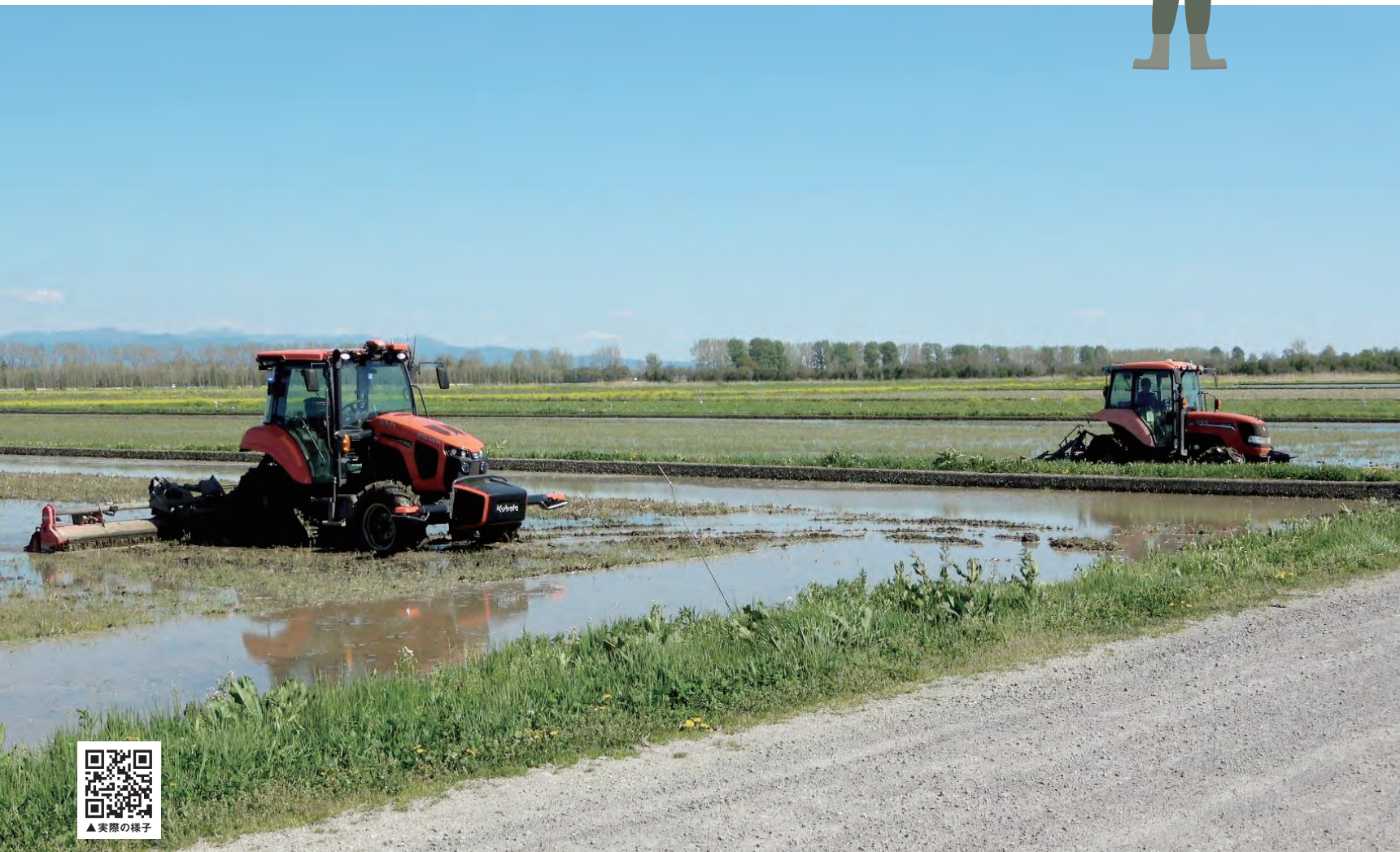
無人ロボットトラクター(左)と有人トラクター(右)による協働作業
