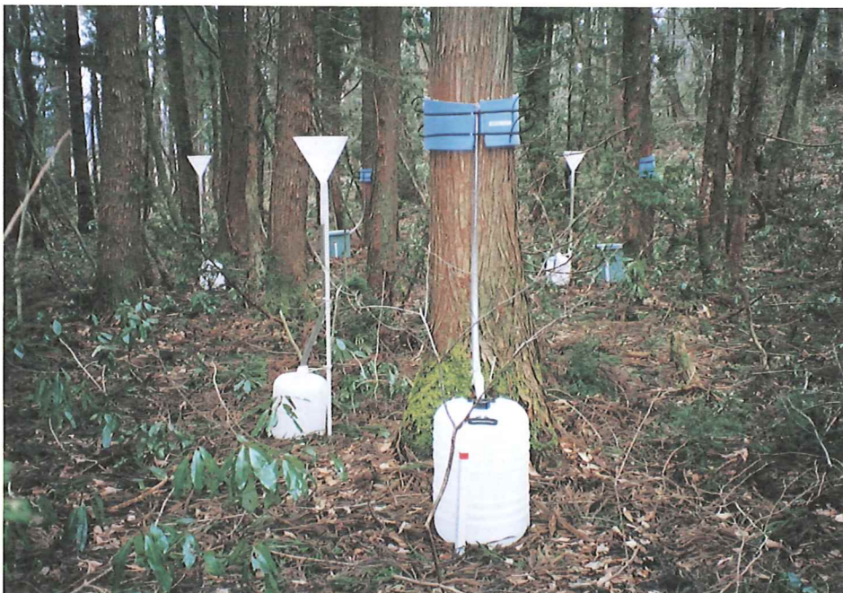
写真－３．スギの樹幹流採取の様子
