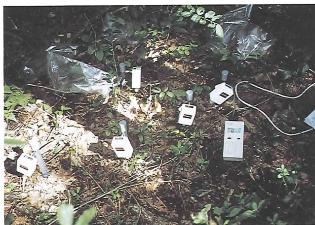
写真9 テンションメーターでの測定
