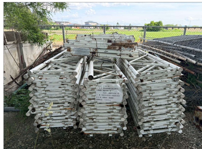
NO.20 転落防止柵
