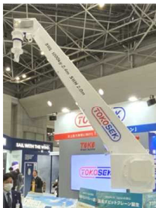
ダビットクレーン
