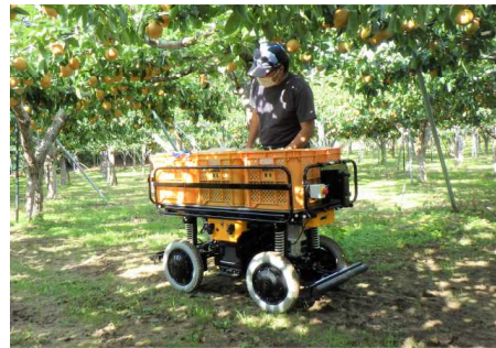
【小型多機能ロボットを活用した収穫作業】
