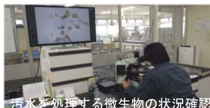
汚水を処理する微生物の状況確認
