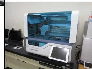
追加した自動核酸精製装置
