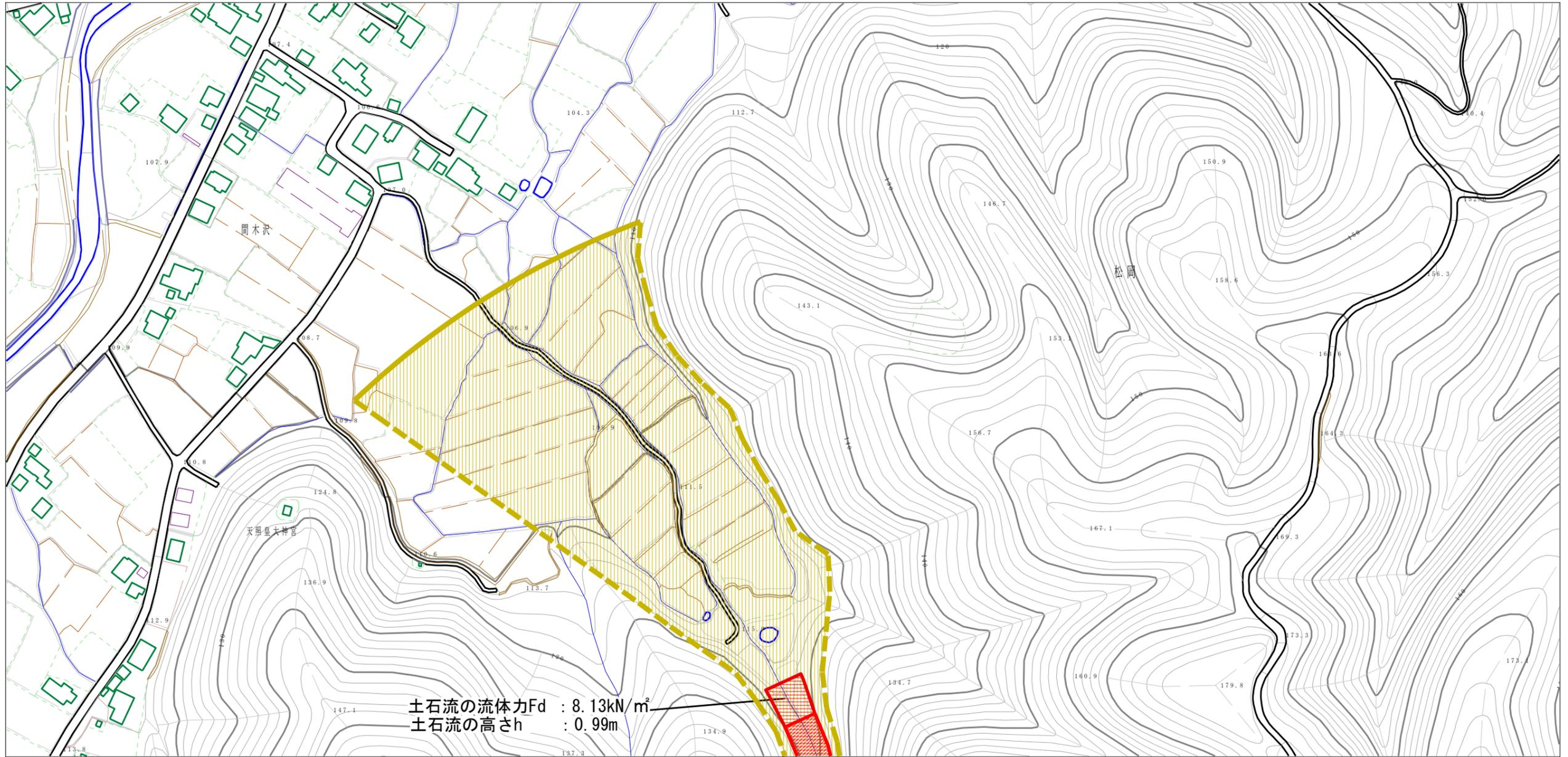
土石流の流体力 $F_d$  : 8.13kN/m<sup>2</sup>
