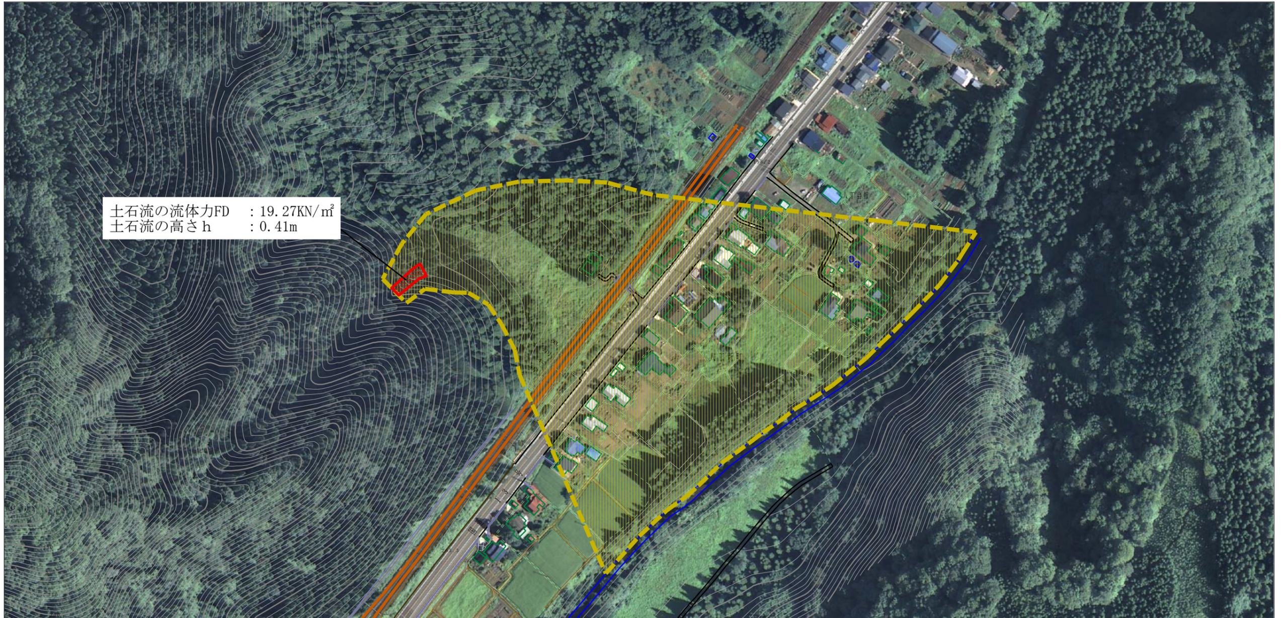
土石流の流体力FD : 19.27KN/m<sup>2</sup>
