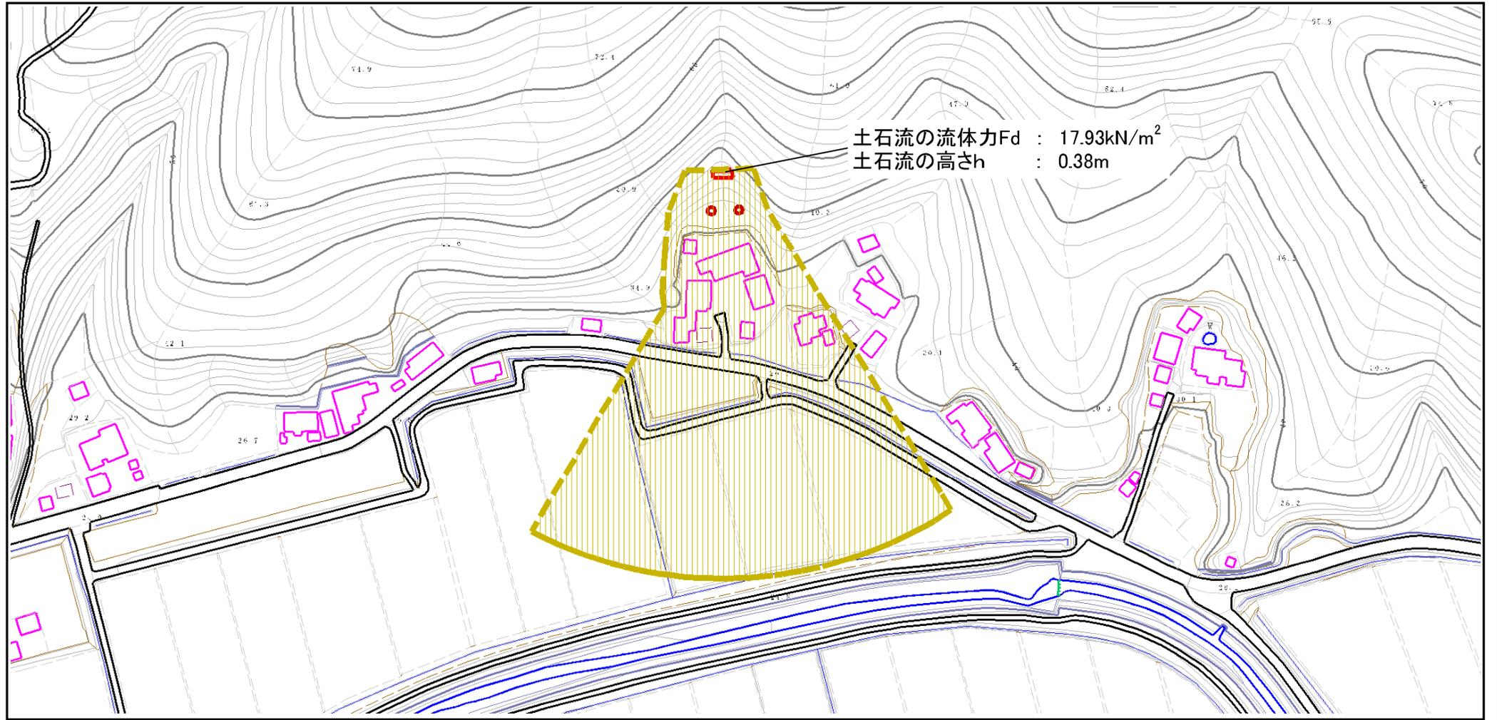
土石流の流体力Fd : 17.93kN/m<sup>2</sup>
