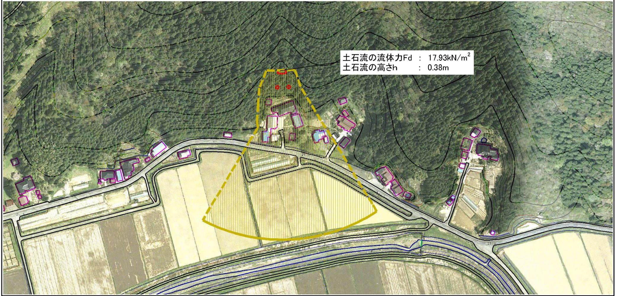
土石流の流体力Fd : 17.93kN/m<sup>2</sup>
