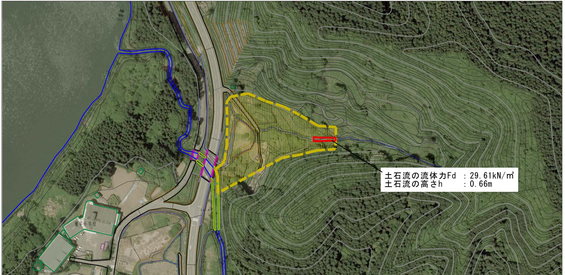
土石流の流体力 $F_d$  : 29.61kN/m<sup>2</sup>
