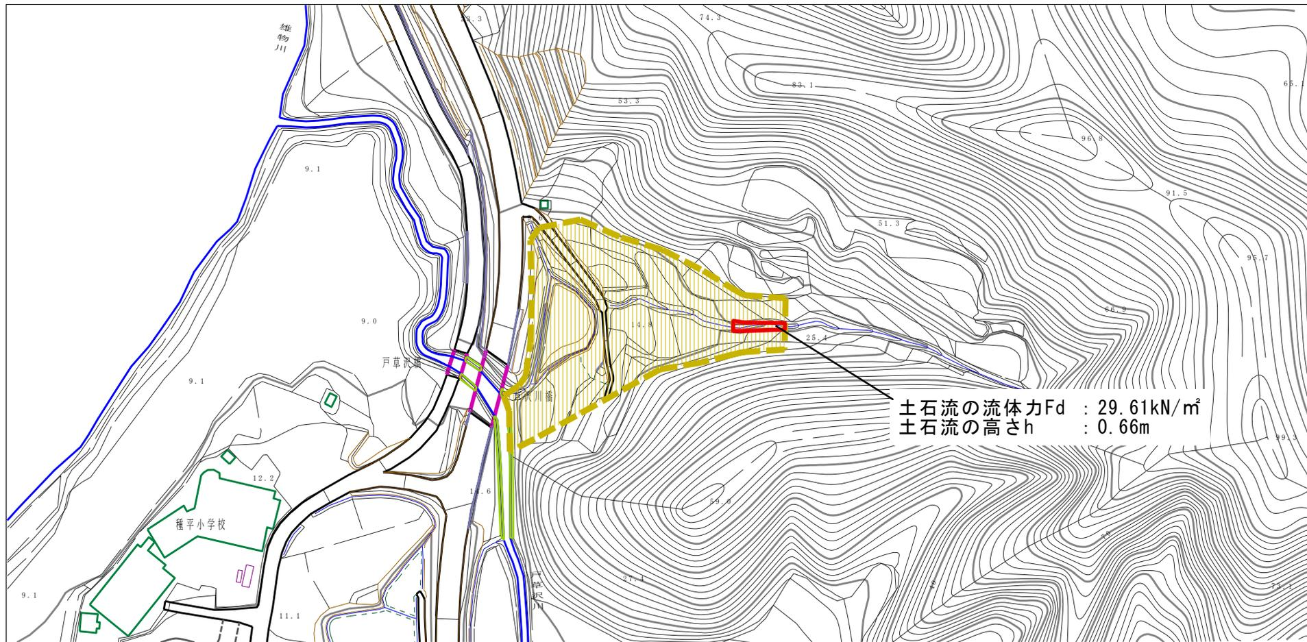
土石流の流体力 $F_d$  : 29.61kN/m<sup>2</sup>
