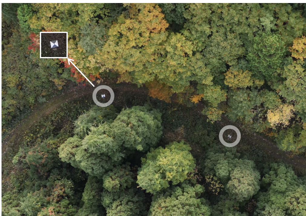
図 3. 1.4 対空標識を設置した撮影の例
