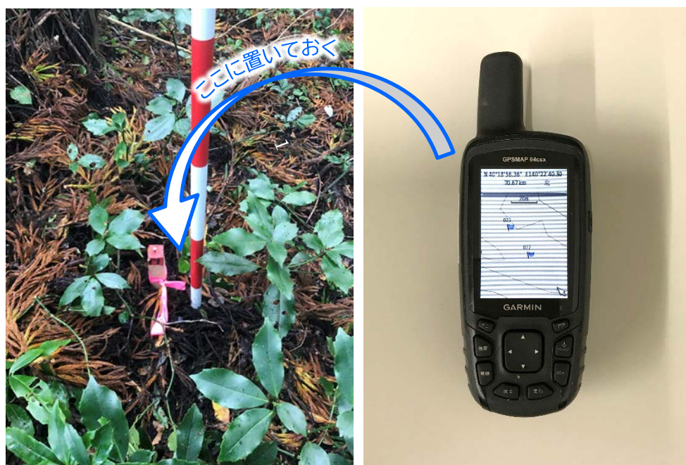
図 6. 2.9 プロットの中心杭とハンディ GNSS 受信機
