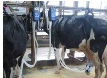
搾乳風景(搾乳後、ミルカーが自動で離脱する)
