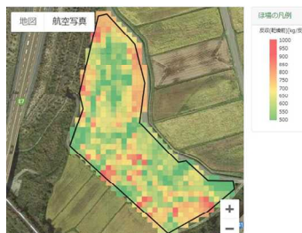
収量コンバインによるほ場マッピング
