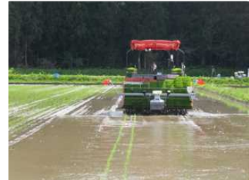
ロボット田植機による自動条数調整
