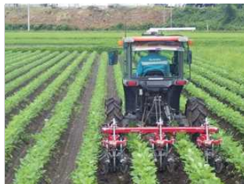
RTK-GNSS自動操舵システムによる中耕・培土作業(ディスク式)
