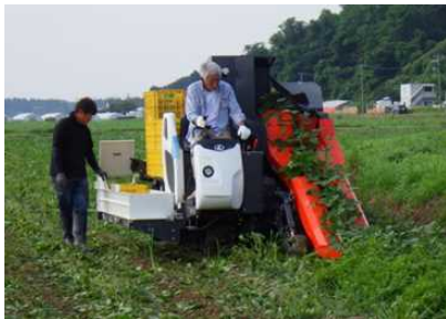
えだまめコンバイン (クボタ製EDC-1100)
