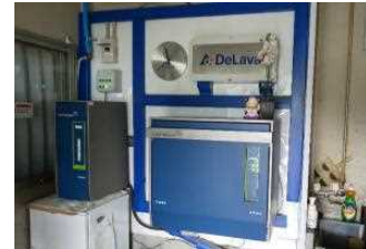
隣接するサンプルインターユニット(左)と分析ユニット(右)
