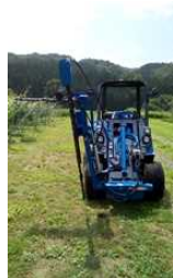
多目的作業車 (「ぶどう畑用トリマー」装着時)
