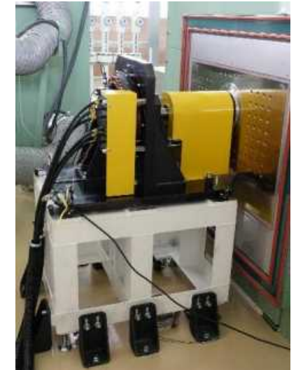
航空機推進系大出力モーター試作品
