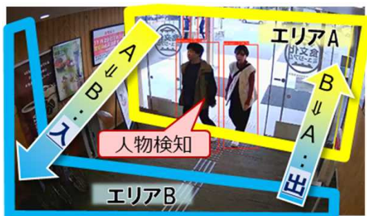
AI画像解析により方向別の通過人数を自動計測
