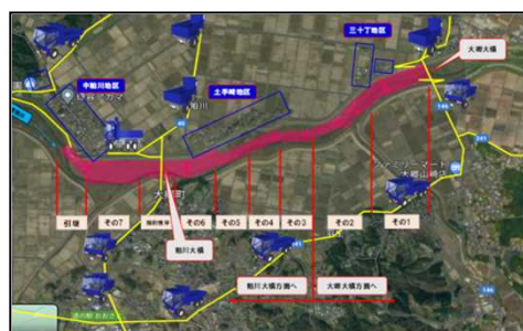
河道掘削時のダンプ運搬台数は約1,440台
